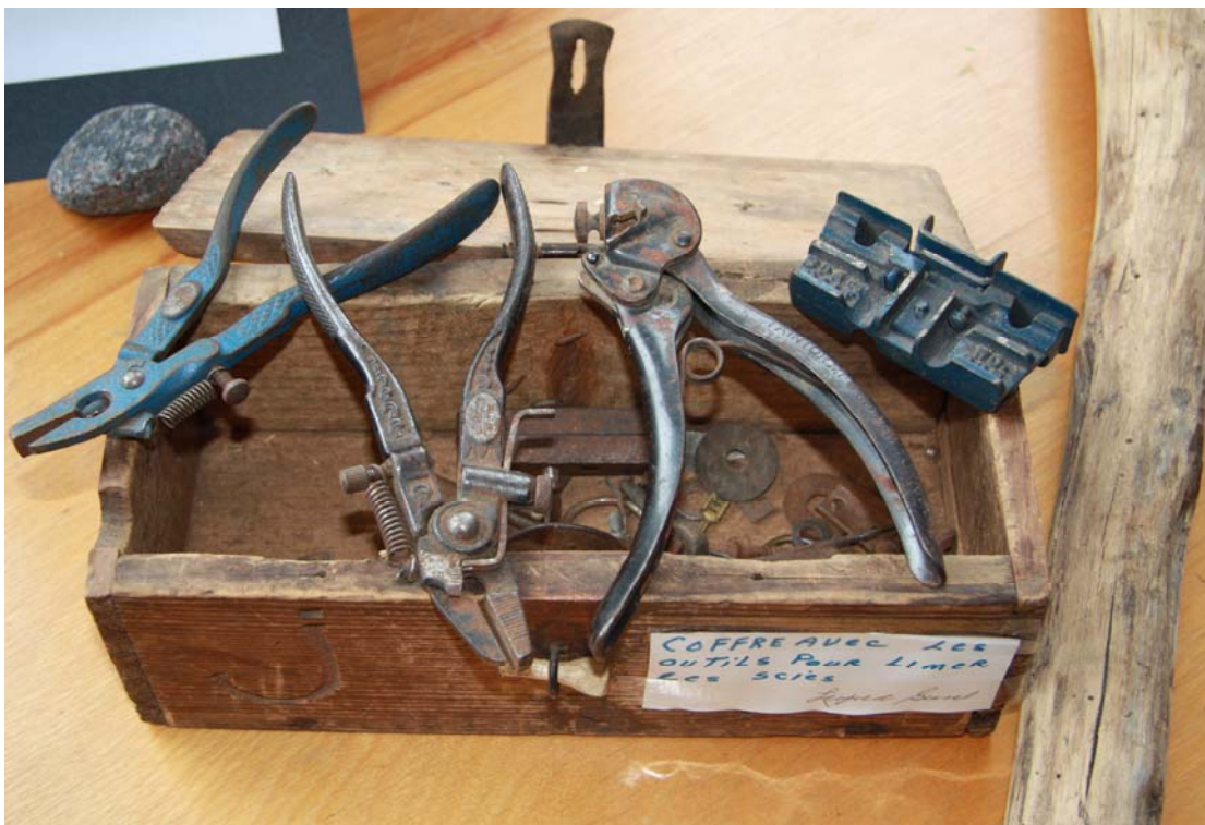
Petits outils servant à limer les scies et à donner du chemin à la lame. Source : Pierre Valois
